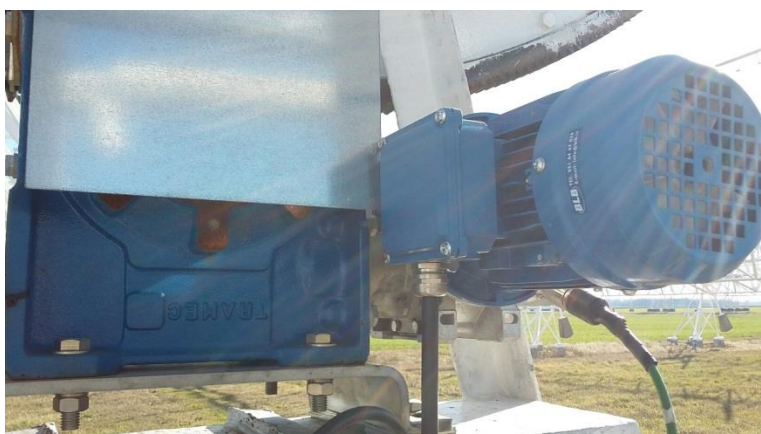
Figure 3-3 motoriduttore di prova installato
