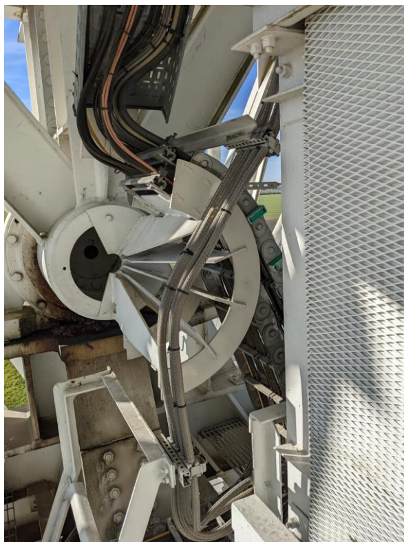
Figura 14-1 Linee flessibili dell'elio nel punto di "snodo" in elevazione
