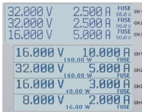
Abb. 4.7: R&S®HMP2030/ R&S®HMP4040 Fuse- Darstellung im Display
