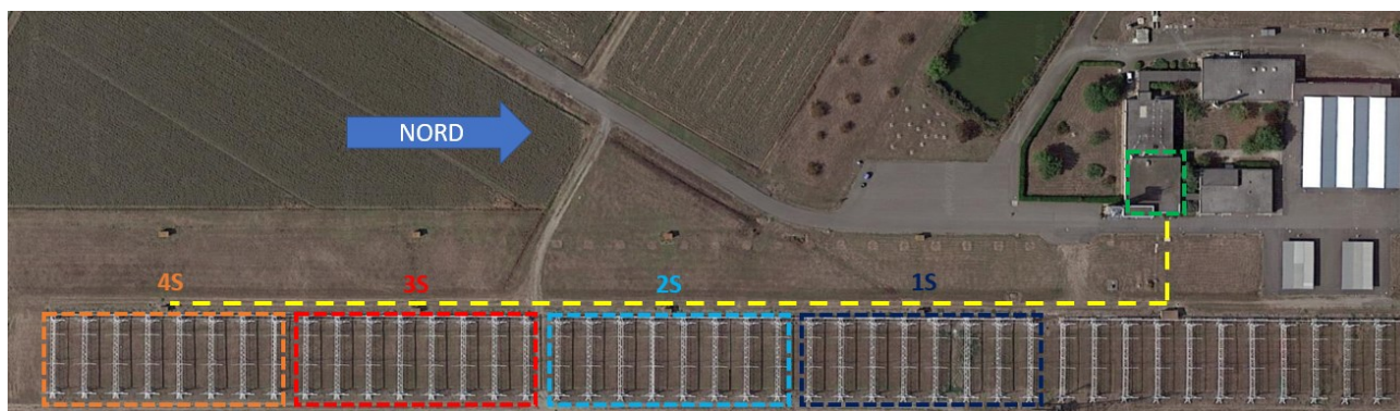
Figura 2. Gruppi di antenne del Radiotelescopio Croce del Nord oggetto dell'intervento: 1S, 2S, 3S e 4S. In giallo è indicato il percorso del cavidotto interrato dalle cabine all'edificio centrale dove si trova la stanza degli apparati (verde).
