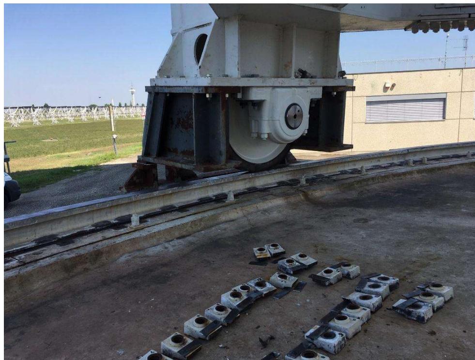
Figura 3 Gruppo ruota folle e rotaia installati
